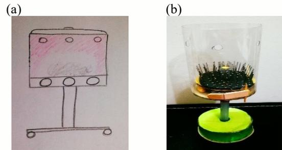
圖 7. 金紙桶初步改良設計示意圖。(a)改良版金紙桶身的高度與底座可調整、孔洞加大，以降低悶燒不完全情形；(b) 金紙桶初步改良設計雛型。
